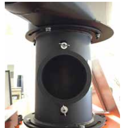
Connexion de l'électrofiltre juste en dessous de l'extracteur de fumées.
