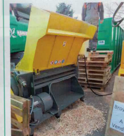
Les palettes sont chargées par le haut du broyeur et avancent par gravité vers le rotor.
