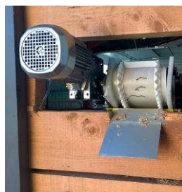
Le broyeur à palette SPE 1300 possède un rotor lent muni de 36 dents en carbure de tungstène. Entraîné par un moteur de 18,5 kW, il est alimenté par une ouverture étroite et sécurisante. Ce modèle spécialement modifié pour l'ESAT possède un tapis magnétique permettant d'évacuer les clous (photo en bas à droite).
