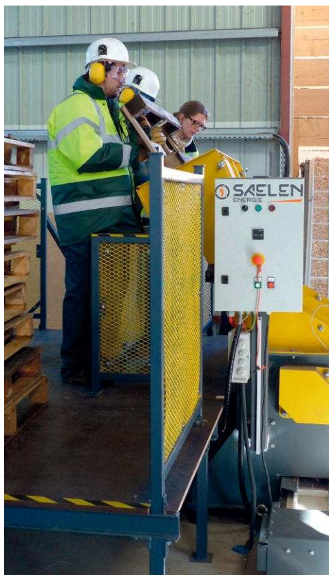
Le broyeur à palette SPE 1300 possède un rotor lent muni de 36 dents en carbure de tungstène. Entraîné par un moteur de 18,5 kW, il est alimenté par une ouverture étroite et sécurisante. Ce modèle spécialement modifié pour l'ESAT possède un tapis magnétique permettant d'évacuer les clous (photo en bas à droite).
