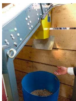
Le deuxième broyeur de l'ESAT, le modèle fixe Heizohack HM 8-400 EM, est entraîné par un moteur électrique de 75 kW. Il traite du bois de 40 cm de diamètre. Les plaquettes (G30 ou G50) sont directement versées dans le silo situé à côté.
