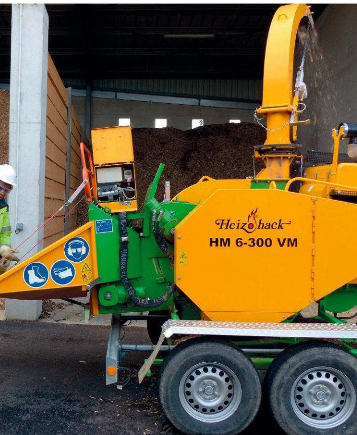
Premier broyeur acquis par l'ESAT, le modèle HeizoHack HM 6-300 VM, monté sur châssis routier et animé par un moteur Hatz, réduit des troncs jusqu'à 30 cm de diamètre. Sa grille de calibrage permet d'obtenir des plaquettes de granulométrie G30 ou G50.
