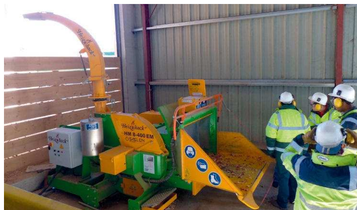
Le deuxième broyeur de l'ESAT, le modèle fixe Heizohack HM 8-400 EM, est entraîné par un moteur électrique de 75 kW. Il traite du bois de 40 cm de diamètre. Les plaquettes (G30 ou G50) sont directement versées dans le silo situé à côté.
