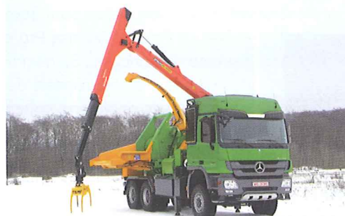
Le HM 14-800 KL, plus gros modèle de la gamme Heizohack, est monté sur un camion Mercedes Actros de 440 chevaux et accepte des troncs de 80 cm de diamètre.
