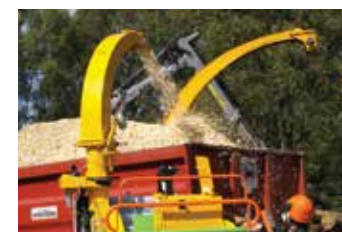
Tourelle orientable à 380° et casquette d'éjection réglable.
