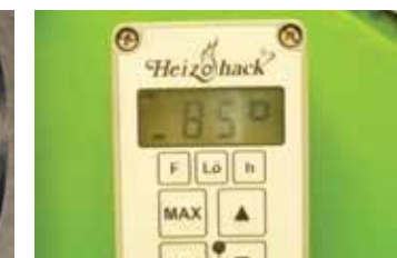
Système de commande no-stress Heizhack HE 002 pour réguler l'avancée du bois à déchiqueter en fonction de la puissance d'entraînement.
