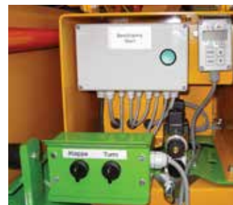
Armoire de commande avec montage en étoile-triangle.
