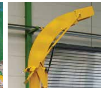
Tourelle orientable à 380° et casquette d'éjection réglable.
