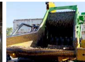
Tapis ameneur avec galets en Hardox durée de vie x4
